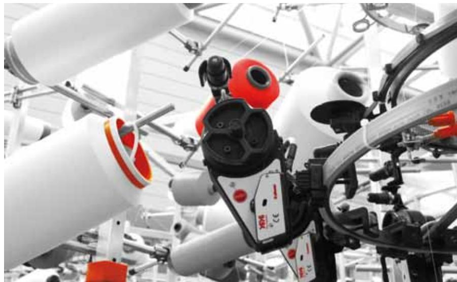
**YOYO** è un dispositivo in grado di controllare l'alimentazione del filato nelle macchine tessili, (circolari grande diametro, seamless e per calze, rettilinee ecc.) con una grammatura programmata
