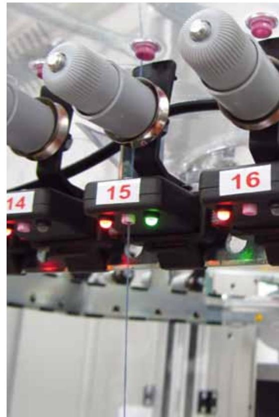
**SPYDER** è un sensore in grado di rilevare lo scorrimento del filato nelle macchine tessili circolari (grande diametro, seamless e per calze).
